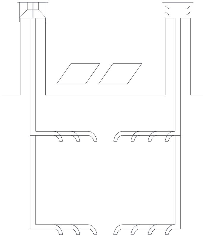
Una instalacion de admision (derecha) con lamas inclinadas hacia dentro y una instalacion de extraccion (izquierda) con efecto venturi con varios conductos ramificados y placas fotovoltaicas.
