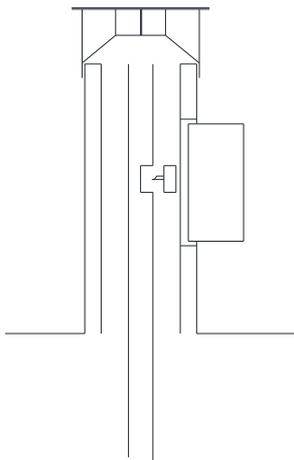
**Ejemplo de instalacion.** un remate venturi y un ventilador accesible en la cubierta
