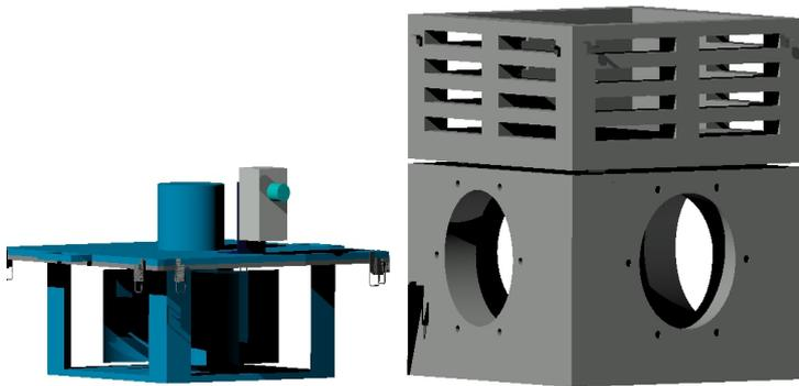
COLECTOR EN CUBIERTA DE PIEDRA ARTIFICIAL POR EJEMPLO HORMIGON POLIMERO O GEOPOLIMEROS. VENTILADOR HIBRIDO, MECANICO O CONTROLADO MEDIANTE SENSOR DE CO2.
