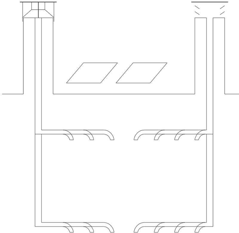
**Ejemplo de instalacion es hibrida y fotovoltaica. Admision y extraccion con conductos ramificados uno o mas ventiladores pueden estar en el remate en tramos intermedios o en el arranque de los conductos hay placas fotovoltaicas y baterias conectadas con la instalacion para ahorrar energia. Como opcion de instalacion la parte electrica; ventiladores y sensores se comunican con, al menos, el interruptor, el programador horario o el sensor de CO2 de modo inalambrico.**
