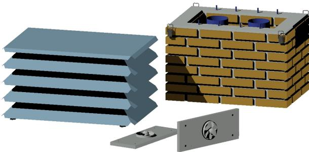
**Chimenea cerrada por arriba con piedra artificial para evitar la condensacion en el interior de los conductos. Estructura del ventilador sujeto en piedra aticicial.**
