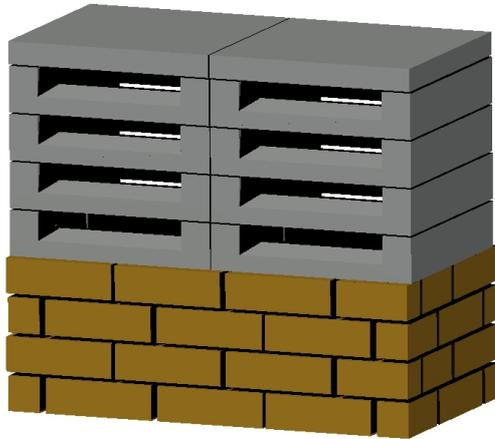
COLOCAMOS REMATES DE HORMIGON ESPECIFICAMENTE DISEÑADOS PARA PAREADOS QUE INDEPENDIZAN AMBAS VENTILACIONES .
